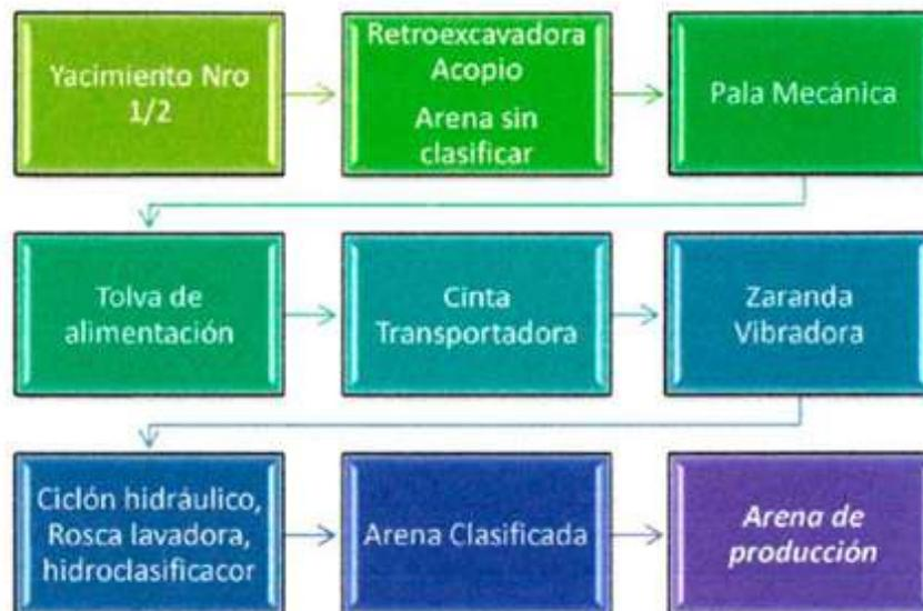
Figura V 42. Diagrama de flujo del proceso
