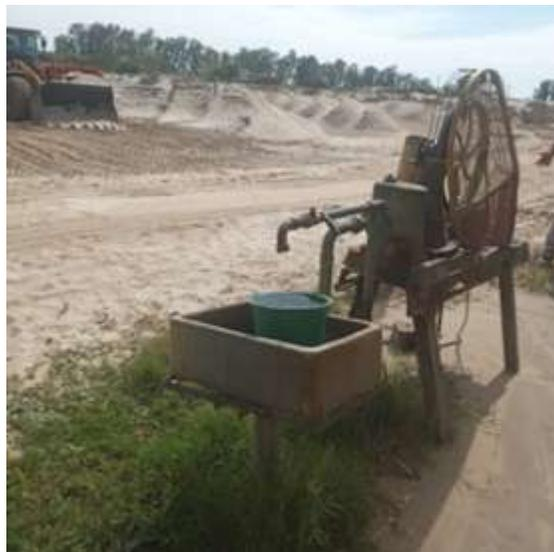
Figura V 72. Bomba de extracción de agua para uso sanitario.
