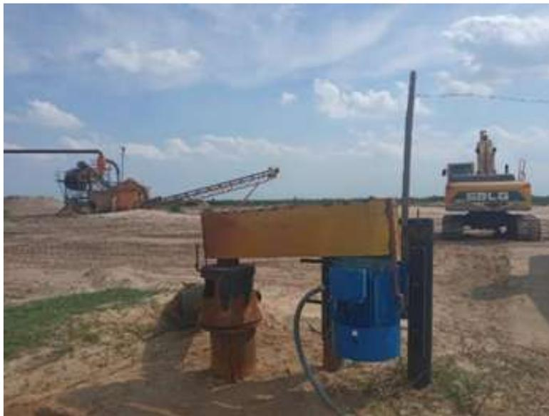
Figura V 46. Pozo de extracción de agua con bomba.
